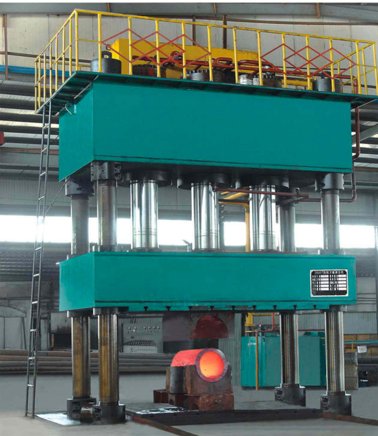
3500 吨压机，可承 搅加工生产有缝无缝 高压管件
